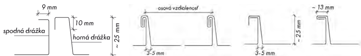
Obr. 2b: Geometria profilu dvojitej stojatej a uhlovej stojatej drážky
