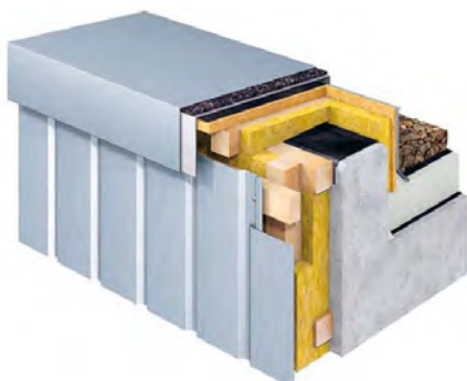
Obr. č.1a: Príklad realizácie oplechovania bez priameho kotvenia (zdroj: RHEINZINK):
