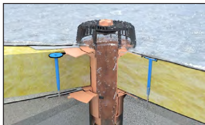
Obr. č.6 – detail odvodnenia dvojúrovňovým vpustom
