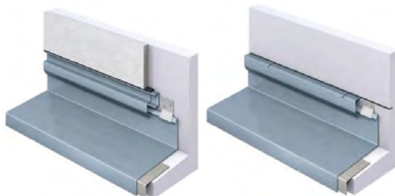
Obr. č.12: Príklad bočného ukončenia pri stene, min. výška v závislosti od sklonu strechy 80/100/150 mm (zdroj RHEINZINK):
