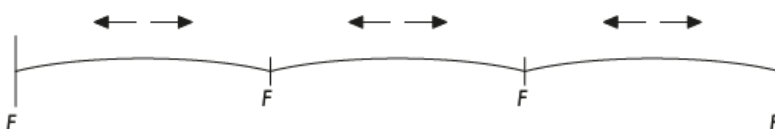
Obr. č.11c: Príklad riešenia líniového oplechovania pri žľabe / štíte - dilatácia, zohľadňujúca rozťažnosť všetkých konštrukcií. Dilatácia je napajkovaná na priebežné oplechovanie, ktoré je v danom mieste prerušené (zdroj RHEINZINK):
